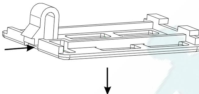
При замене лампы отключите холодильник от электросети. Освободите фиксатор плафона, сдвинув его от края к центру (см. рисунок). Подцепив плафон торцевой отверткой, потяните его вниз и снимите. Замените лампу. Установите плафон, вставив сначала выступы в окно кронштейна со стороны патрона лампы, а затем слегка нажмите на другую сторону плафона, чтобы фиксатор вошел в окно кронштейна.
